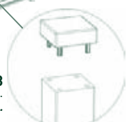
Figure 8 / Abbildung 8 Attachment of the post cap. Fixation du chapeau de finition. Anbringen der Pfostenkappe.
