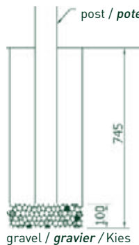
Figure 2 / Abbildung 2 Préparation of post holes. Préparation des trous pour poteaux. Vorbereitung der Pfostenlöcher.
