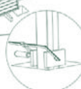
Figure 4 / Abbildung 4 Locating blocks onto the fence posts. Installation des cales sur le poteau. Fixieren von Kanthölzern am unteren Ende des Pfostens.
